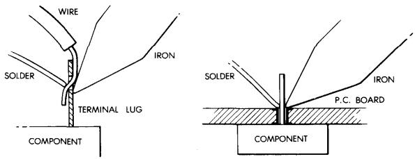
TOUCH THE SOLDER TO THE JOINT, AS SHOWN ABOVE, JUST LONG ENOUGH TO MELT ENOUGH SOLDER TO FORM A FILLET ON THE JOINT. TOO MUCH SOLDER MAY SHORT CIRCUIT THE BOTTOM OF THE BOARD OR FLOW THROUGH THE HOLES AND WICK INTO THE SOCKETS. THE MELTED SOLDER WILL APPEAR WET AND SHINY. IT WILL QUICKLY FLOW COMPLETELY AROUND THE WIRE AND OVER THE SURFACE TO WHICH THE WIRE IS ATTACHED.
