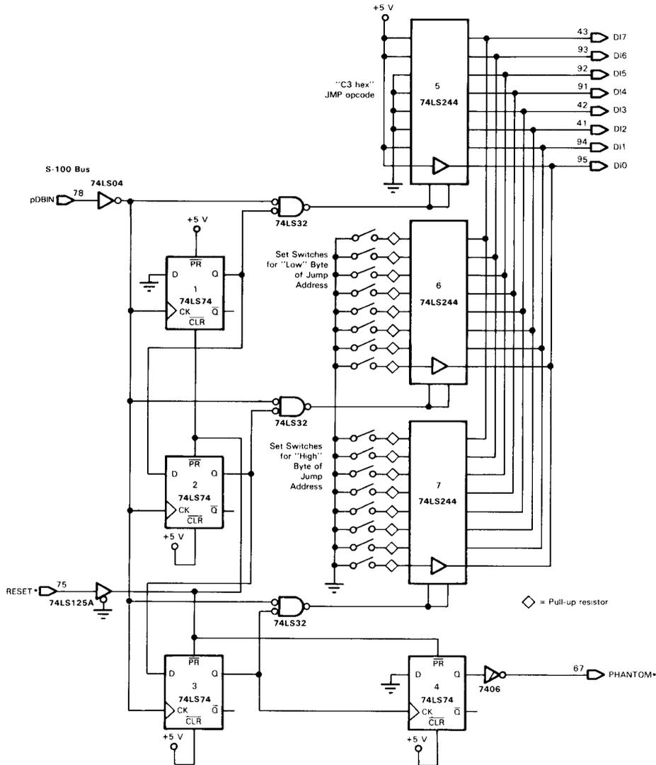
FIGURE 16-5. Jump-On-Reset Circuit
