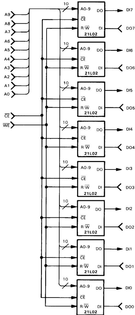
**FIGURE 6-2.** 1K  $\times$  8 RAM Using Eight 21L02s
